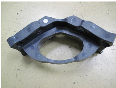
試験後の耐震リングR10
