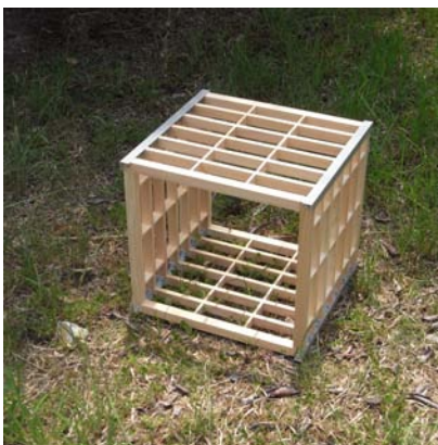
図2 耐震シェルターを目的とした「モノコック構造体」 15) とその鉛直載荷実験 (GBRC)
