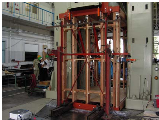
図2 耐震シェルターを目的とした「モノコック構造体」 15) とその鉛直載荷実験 (GBRC)
